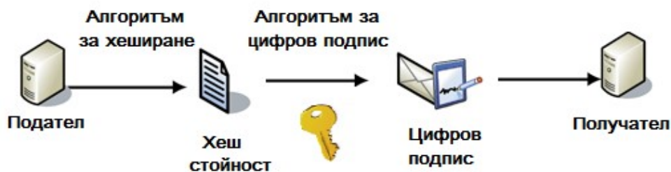
Фиг.2:Принцип на действие на електронния подпис.
