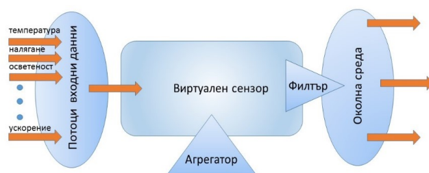
Фиг.1.Модел на виртуален сензор [11]
