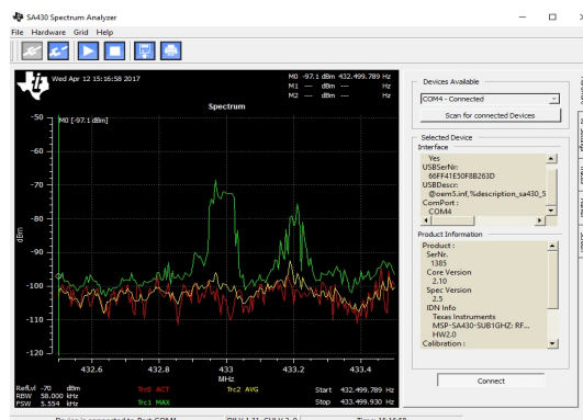
Фиг.7. Анализиране на сигнал с честоти между 389-464 MHz с център 433 MHz
