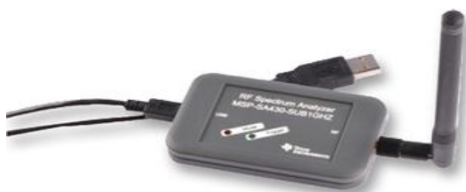
Фиг.4. Хардуерната част на интелигентен спектроанализатор тип MSP-SA430-SUB1GHZ
