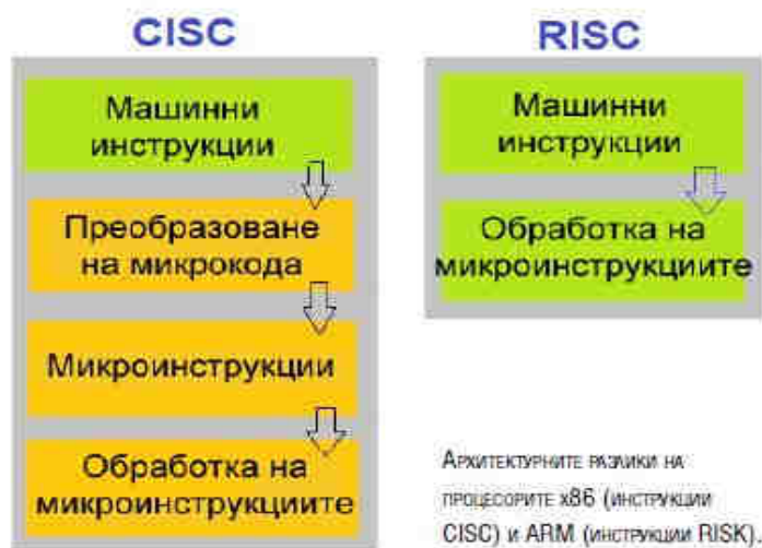
Фиг. 1. Архитектурни разлики на процесорите x86/инструкции CISC и ARM инструкции/ RISC.
